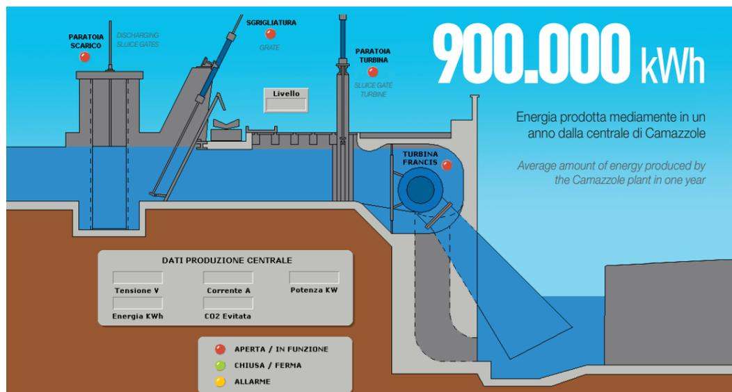
Quadro sinottico della centrale, per la visione immediata di tensione (V), corrente (A), potenza (kW), energia (kWh) e CO<sub>2</sub> evitata.
