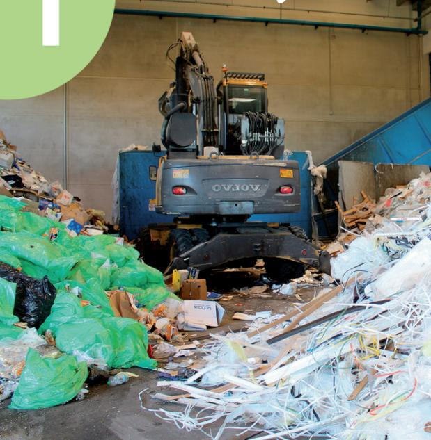
Dopo la pesatura i rifiuti vengono scaricati a terra nell'apposita area, dove col ragno meccanico saranno alimentati nella tramoggia di carico. In fase di alimentazione l'operatore del ragno esegue una prima sommaria cernita, evitando di caricare quei materiali (es. reggette per imballaggi) che potrebbero interferire con l'azione del vaglio balistico, al fine di preservarne la funzionalità.
